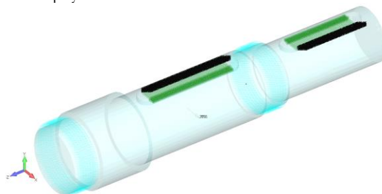
Figura 6. Detalle del modelo de análisis e indicación de las presiones sobre los laterales de las ranuras para chavetas.
