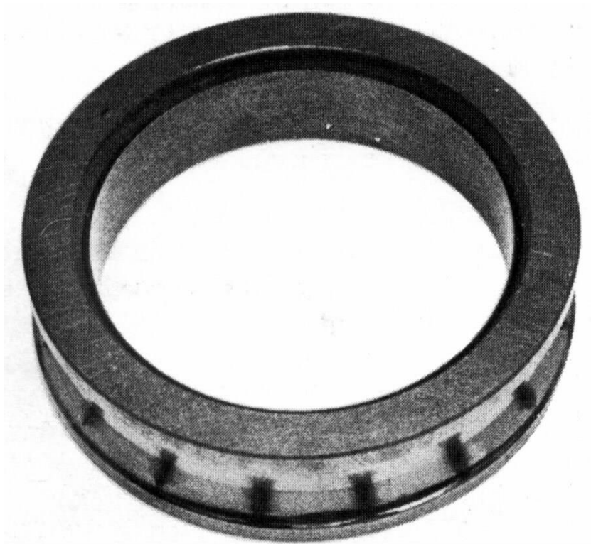
Figura II-2-16: falso brinelling en la pista interior de un rodamiento de bolas [3].
