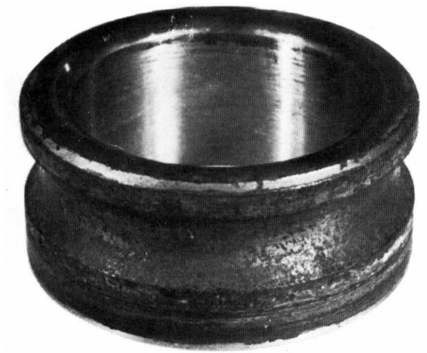
Figura II-2-10: daño muy avanzado por corrosión [3].
