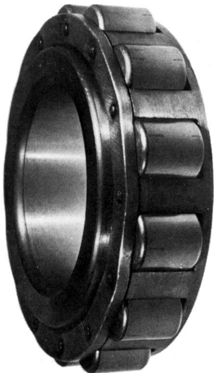
Figura II-3-22: marcas por arranque de material en la generatriz del rodillo de un rodamiento radial de rodillos debido a la introducción forzada en la pista de la figura II-3-23.
