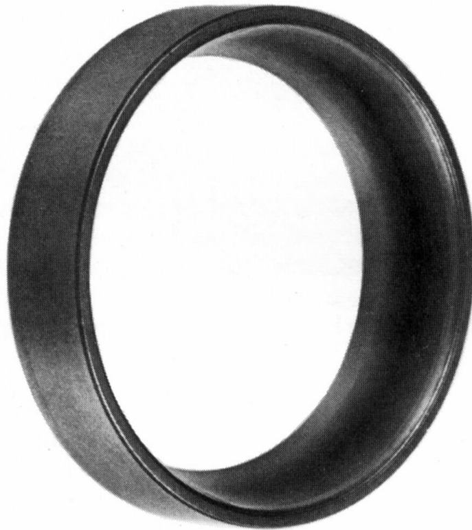
Figura II-4-12: coloración debido a la exposición a altas temperaturas [3].
