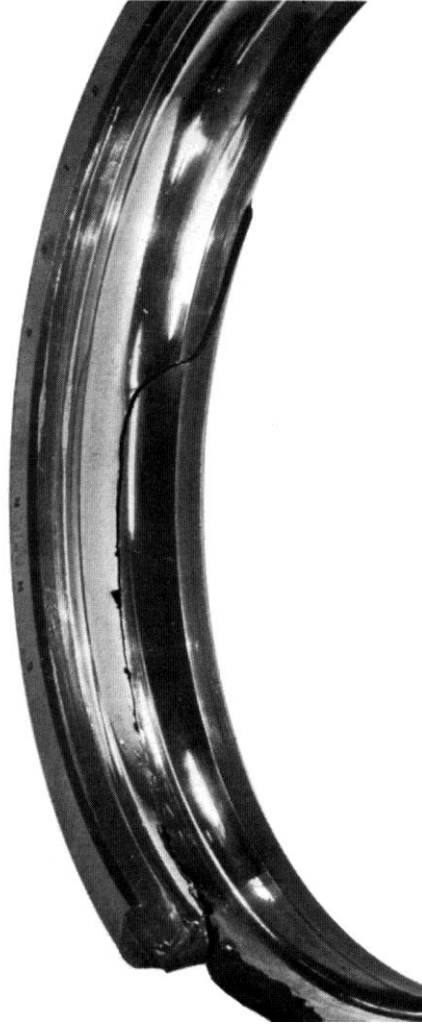
Figura II-3-5: rotura por exceso de interferencia de montaje [3].
