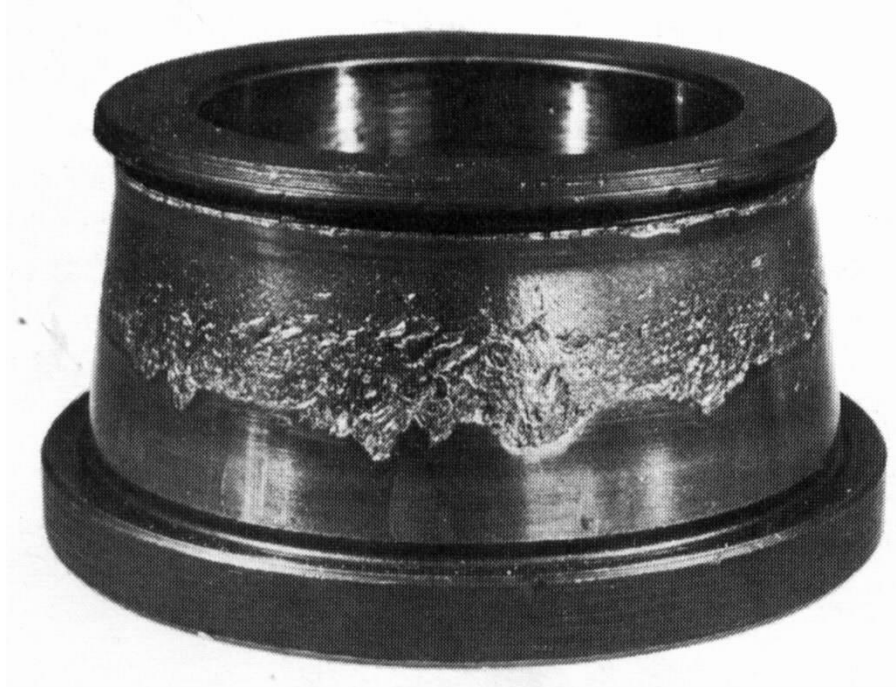
Figura II-3-8: exfoliación localizada debido a mecanizado cónico del apoyo [3].
