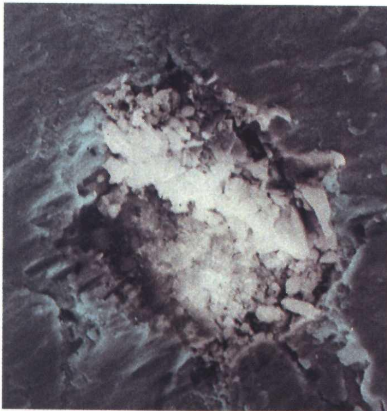
Figura I-8: Inclusión de óxido de aluminio en lugares de iniciación de fallas por fatiga que se han observado en ensayos de flexión rotatoria, en acero SKF 3. Fotografía de aumento x1000 [10].
