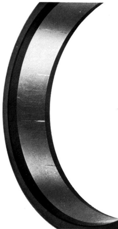
Figura II-3-23: marcas por arranque de material en la pista de rodadura del aro exterior de un rodamiento radial de rodillos debido a la introducción forzada de la pieza de la figura II-3-22
