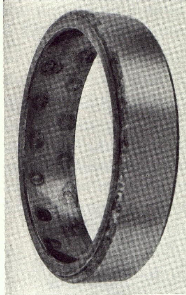
Figura II-2-4: Marcas de corrosión entre los elementos de rodadura y la pista, debidos a una grasa inadecuada
