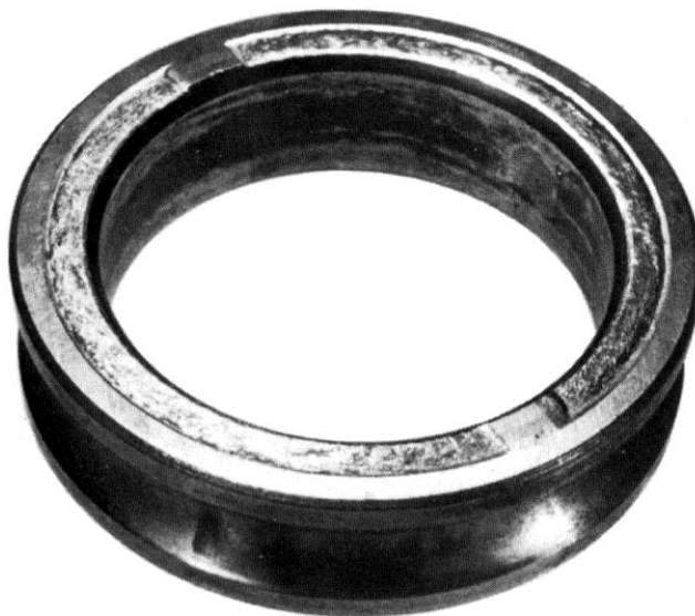
Figura II-2-20: corrosión de contacto muy avanzada con pérdida de material [3].
