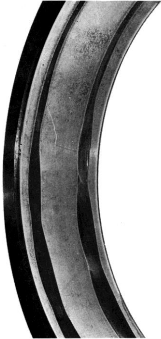
Figura II-1-21: surco producido por impurezas [3]
