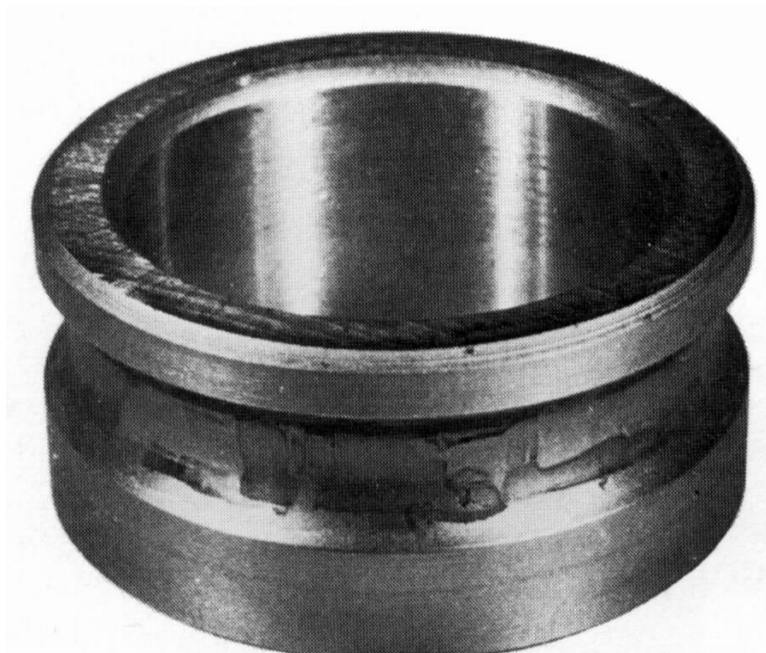
Figura II-2-7: marcas por corrosión [3].
