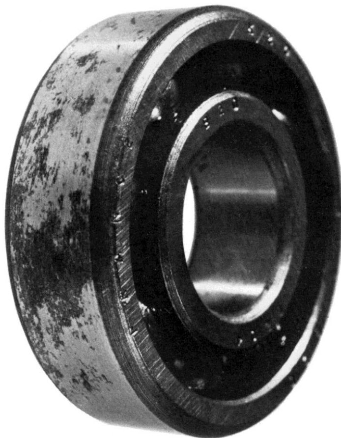
Figura II-2-21: corrosión de contacto [3].
