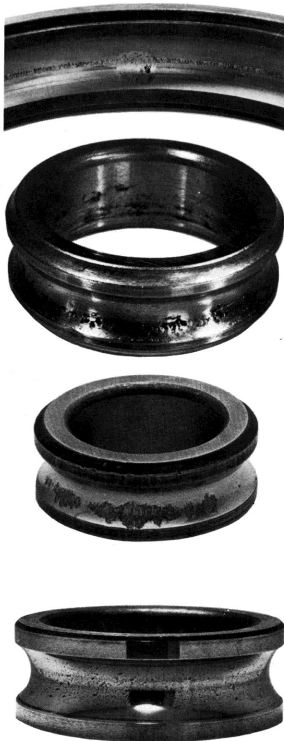
Figura II-1-4: diferentes ejemplos de exfoliaciones superficiales debidas a deficiencias en la lubricación [3]
