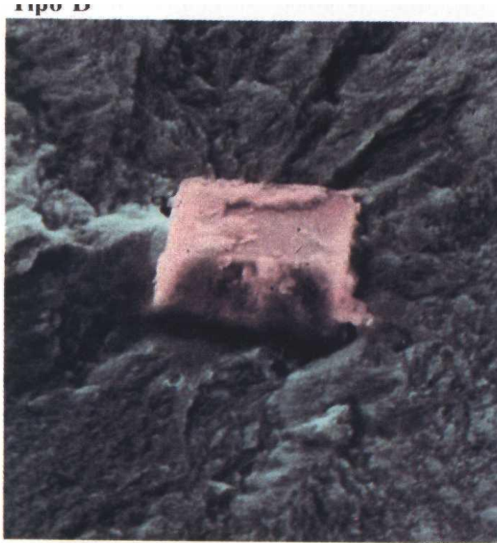
Figura I-10: Inclusión de carbonitruro de titanio en lugares de iniciación de fallas por fatiga que se han observado en ensayos de flexión rotatoria, en acero SKF 3. Fotografía de aumento x1000 [10].
