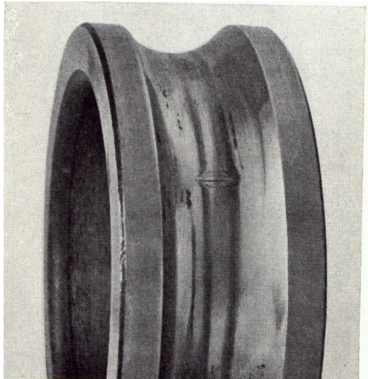
Figura I-1: exfoliación inicial por fatiga en la pista de rodadura interna de un rodamiento de bolas [2].
