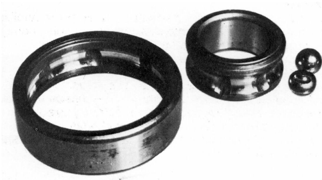
Figura II-2-17: falso brinelling en ambas pistas de un rodamiento rígido de bolas [3].
