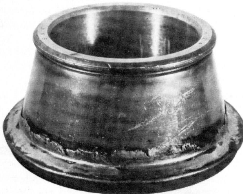
Figura II-1-7: gripado consistente en transferencia de material entre los rodillos cónicos de la figura II-1-8 y la pista interior [3].
