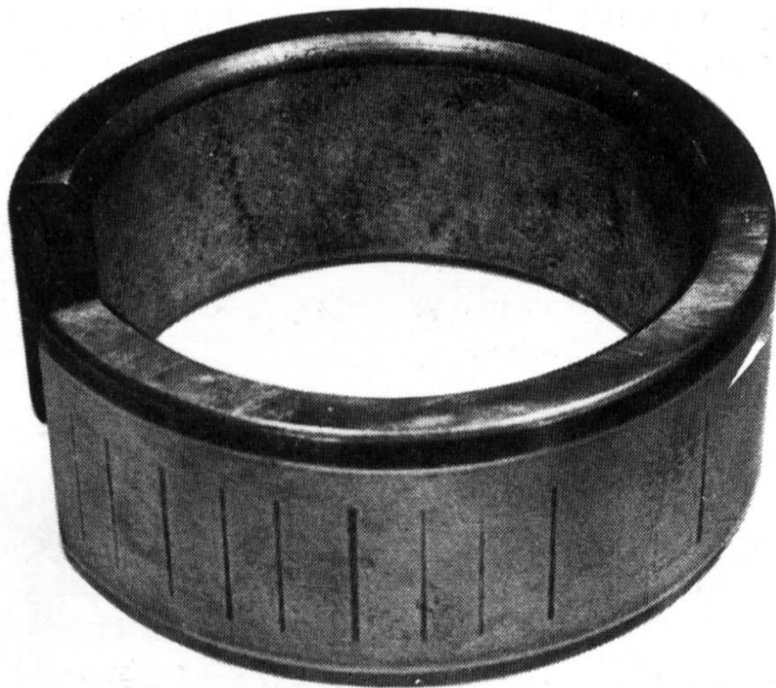
Figura II-2-15: falso brinelling en la pista interior de un rodamiento radial de rodillos [3].
