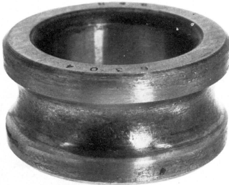
Figura II-1-6: daño por gripado consistente en arranques superficiales de material acompañados de zonas de color mate [3].
