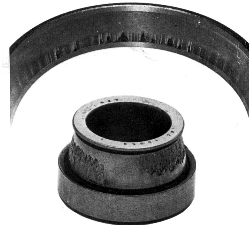
Figura II-3-13: exfoliación debido a concentración de carga sobre determinados sectores de las pistas por desalineación [3].
