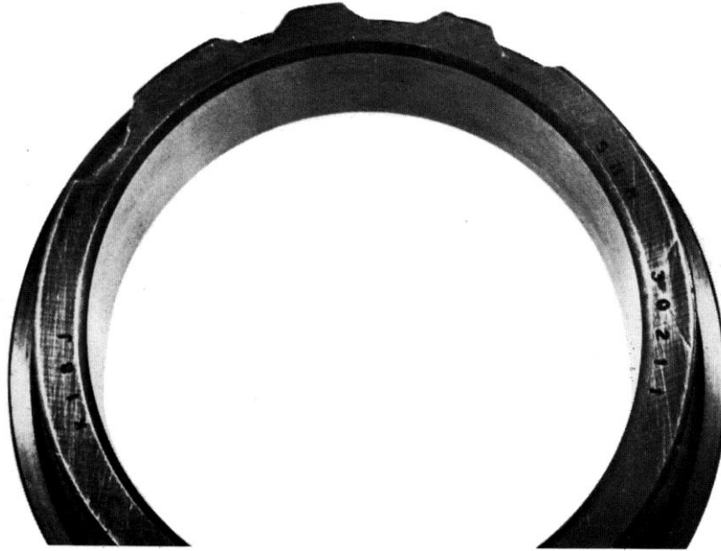
Figura II-3-16: rotura del borde de la pista por percusión durante el montaje [3].
