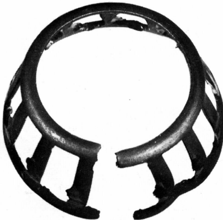
Figura II-1-24: rotura por desgaste abrasivo intenso [3].
