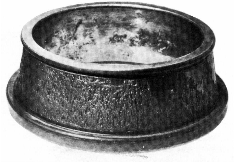
Figura II-1-5: exfoliación distribuida en la totalidad de la pista de rodadura debida a falta de lubricante o sobrecarga momentánea o continua [3].
