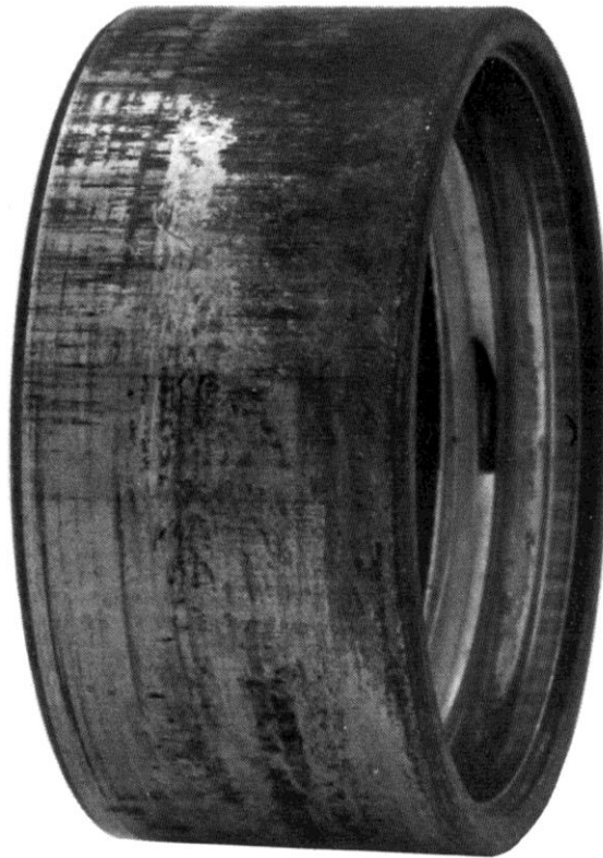
Figura II-2-19: corrosión de contacto [3].
