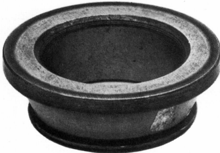
Figura II-4-11: coloración superficial debido a la exposición a alta temperatura [3].
