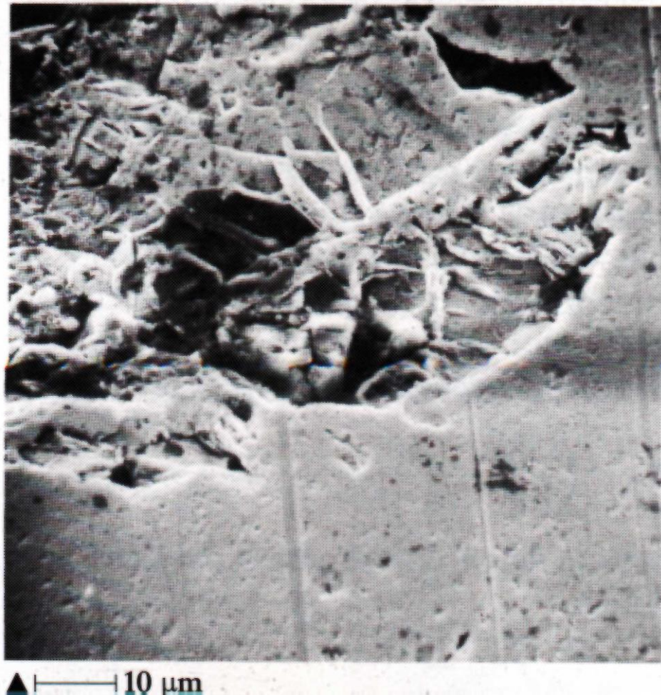
Figura II-1-12: daño en la superficie de rodadura debido a un cuerpo extraño duro. La superficie aún no presentaba síntomas de fatiga [7].
