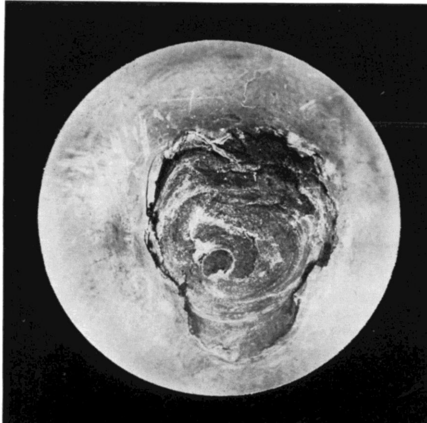
Figura I-4: exfoliación en la superficie de una bola de rodamiento [4].
