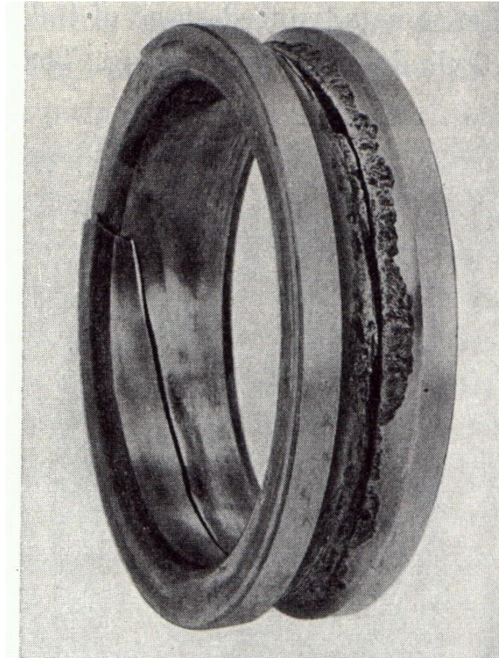
Figura I-7: fractura del aro interno de un rodamiento de bolas debido a las cargas concentradas puntuales producidas al paso de los elementos rodantes por sobre partículas metálicas desprendidas de la exfoliación [2].
