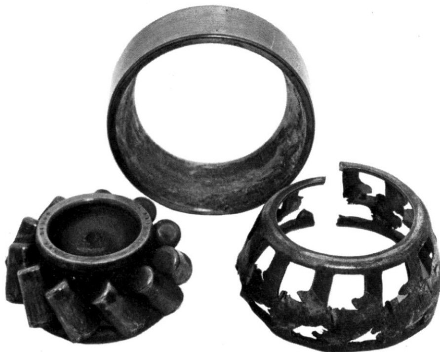
Figura II-1-10: gripado consistente en la soldadura total de los elementos rodantes a los anillos y destrucción de las jaulas [3].
