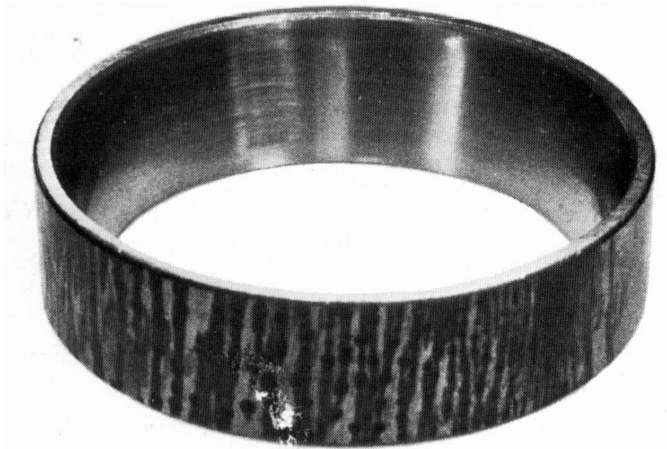
Figura II-2-9: Corrosión en la superficie exterior del aro de un rodamiento de bolas a rótula [3].
